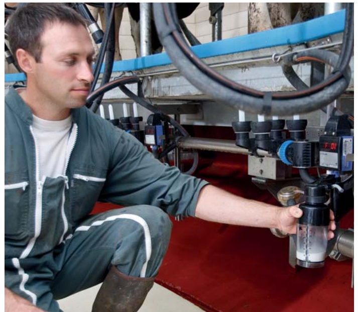
Отбор пробы молока и счетчик MM27BC.
